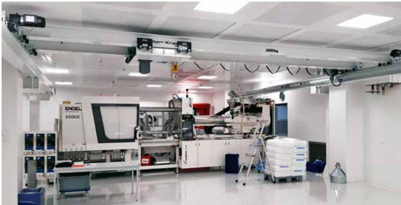
1 En las instalaciones de sala blanca se ha instalado un sistema de grúa especial con un polipasto de cadena. Una cubeta colectora bajo el polipasto protege la zona de producción situada debajo de posibles partículas abrasivas.
