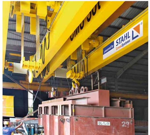
**Ejemplo 2 Polipasto de doble ramal STD para la construcción de una producción en serie**
