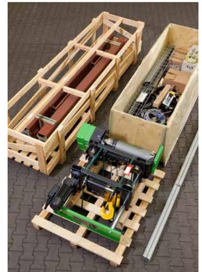
Todo de un vistazo: el CraneKit acabado se entrega premontado y el sencillo principio 'plug and play' facilita el montaje.
