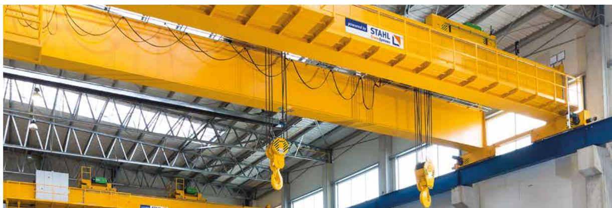
Equipado con vigas de testero de grúa acopladas de serie. Se pueden suministrar ejecuciones especiales sobre solicitud.
